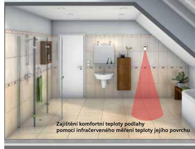
Zajištění komfortní teploty podlahy pomocí infračerveného měření teploty jejího povrchu
